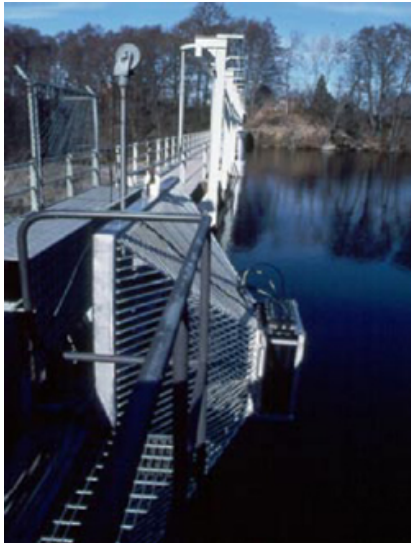
Automatic fish counter installed at Finsjö, Emån.
